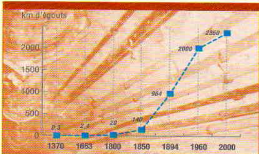
Une croissance exponentielle : extension du réseau d'égouts
